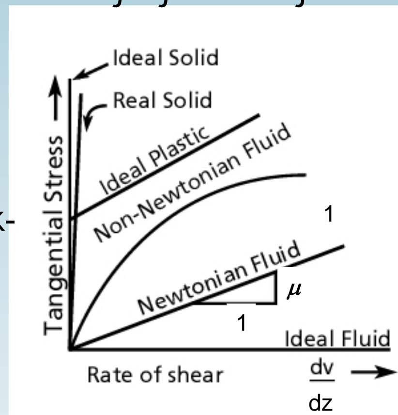
Dimenzija dinamičkog koeficijenta viskoznosti proizilazi iz Njutnovog zakona viskoznosti kada se u izraz unesu dimenzije
